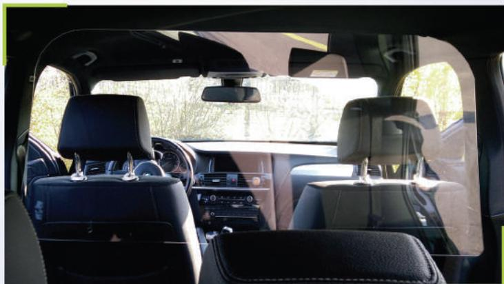
Certaines professions sont amenées à utiliser un véhicule pour le transport de passagers (taxis, VTC, ambulances privées...). Dans l'optique de **protéger les utilisateurs du véhicule, la pose d'une vitre en polycarbonate transparent** séparant le conducteur des passagers est **un geste barrière** de plus. Celle-ci se fait sans modification du véhicule. Nous vous proposons une gamme de **3 dimensions** pour s'adapter au mieux à votre véhicule.
